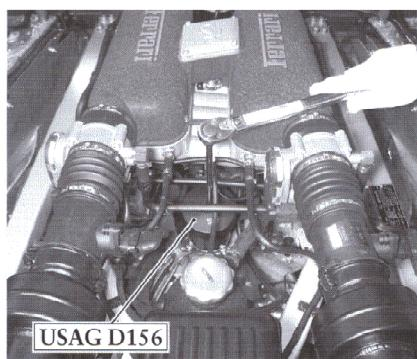
Agli intervalli stabiliti nel PIANO DI MANUTENZIONE PROGRAMMATA, pulire il filtro a rete, posto sul lato destro della scatola cambio, sotto alla flangia di attacco del differenziale.
